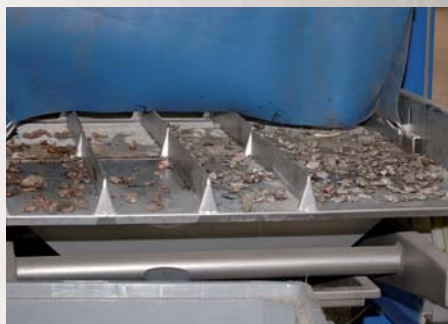
Afb. 2 Met de Bakker LiquiSort kunnen nagenoeg zuivere fracties non ferro-metalen worden afgescheiden
